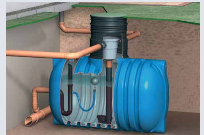
(Einbauschema Aqua'Terne 112 „Retentionstank“)
