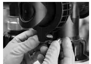
Schritt 16- Die Schellen 9 zusammenschrauben mit M8x30 und Mutter M8 10
