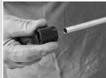
Schritt 19- Kunststoffmutter 13 auf beiden Seiten der Alu-Entnahmeleitung Ø10 16 einfügen
