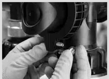
Schritt 12- Die Schellen ⑨ zusammenschrauben mit M8x30 und Mutter ⑩
