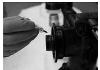
Schritt 12- O Ring an der Erweiterung 14 leicht einfetten 6
