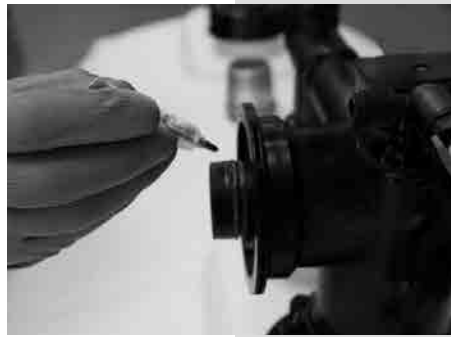
Schritt 8- O Ring an der Grundeinheit ① leicht einfetten ⑥
