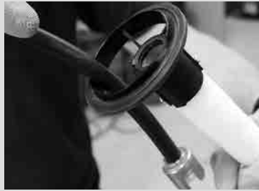
Schritt 2- Entnahmeschlauch 14 durch die große Öffnung des teleskopischen Schaumrohres 2 stecken
