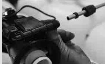
Schritt 3- Entnahmeleitung 16 in die Entnahmewinkel einfügen 25
