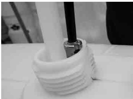
Schritt 4- Teleskopisches Schaumrohr ② maximal aufziehen und mit dem Entnahmeschlauch ① in die Tanköffnung stecken
