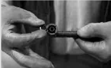
Schritt 1- Gummidichtungen 25 in den Entnahmewinkeln einfügen
