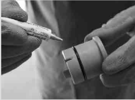
Schritt 13- O Ring am Entlüftungsstopfen ⑪ leicht einfetten ⑥
