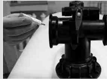
Schritt 7- O Ring an der Grundeinheit 1 leicht einfetten 6
