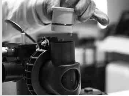
Schritt 14- Entlüftungsstopfen ⑫ in die Grundeinheit oder Entlüftungswinkel Ø 70mm einklipsen ⑧
