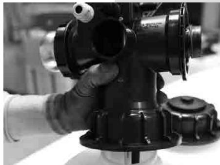
Schritt 5- Grundeinheit ① leicht anschrauben
