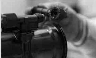
Schritt 2- Entnahmewinkel 16 mit den Gummidichtungen auf die Erweiterungen 13 festschrauben
