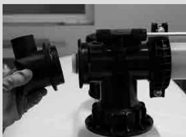
Schritt 14- Entlüftungswinkel Ø 70mm 8 in die Erweiterung 14 einklipsen
