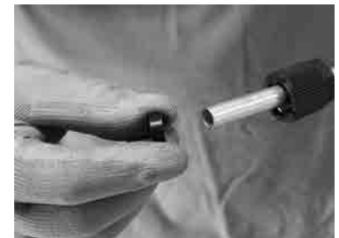
Schritt 20- Entnahmerohrdichtungen 17 auf beiden Seiten der Alu-Entnahmeleitung Ø10 16 einfügen
