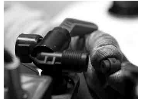
Schritt 17- Entnahmeleitung ① mit dem Gummistöpsel ⑫ abdichten
