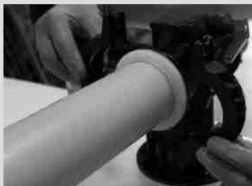
Schritt 10- Erweiterungsrohr an der Grundeinheit 1 und Erweiterung 14 mit Schellen 9 befestigen
