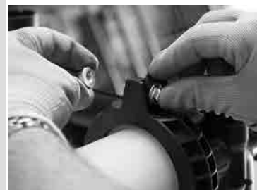
Schritt 11- Schellen 9 mit Schrauben M8x30 und Mutter M8 10 zusammenschrauben
