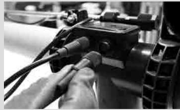
Schritt 8- Kabelstecker 4 an die letzte Erweiterung 14 anbringen
