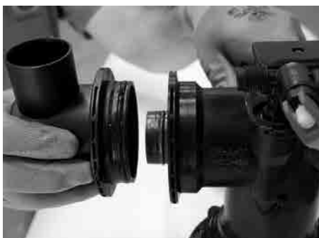
Schritt 10- Entlüftungswinkel Ø 70 mm ⑧ in die Grundeinheit ① einklipsen
