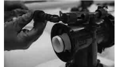
Schritt 4- Entnahmeleitung 16 festschrauben
