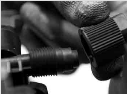
Schritt 18- Gummistöpsel ⑪ mit Kunststoffmutter ⑬ befestigen
