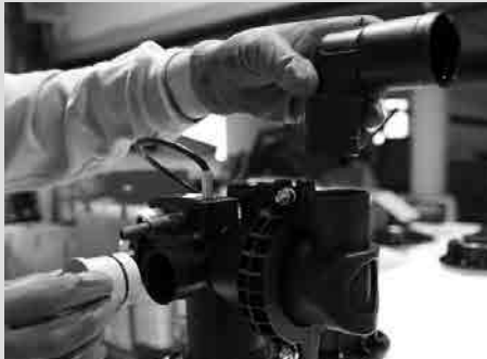
Schritt 15- Entlüftungswinkel Ø 70mm ⑧ verstellbar nach Wunsch
