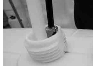
Schritt 4- Teleskopisches Schaumrohr 2 maximal aufziehen und mit dem Entnahmeschlauch 1 in die Tanköffnung stecken
