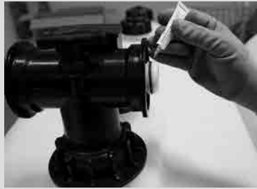
Schritt 6- O Ring an der Erweiterung 14 leicht einfetten 6
