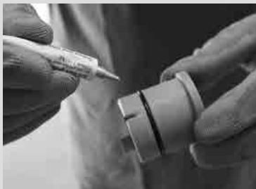
Schritt 17- O Ring am Entlüftungsstopfen 11 leicht einfetten 6
