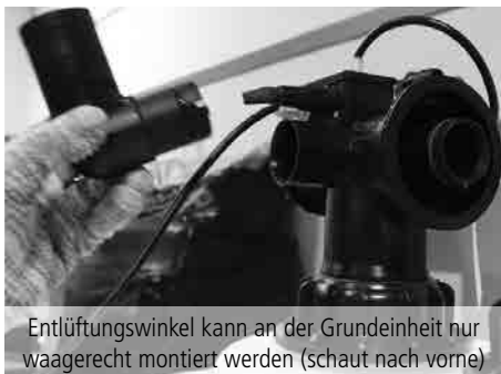
Schritt 7- Entlüftungswinkel Ø 42mm ⑦ in die Grundeinheit ① einklipsen
