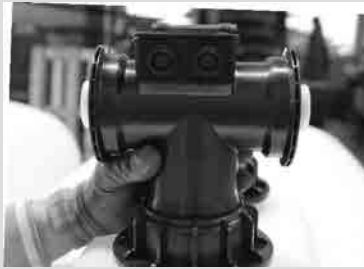
Schritt 5- Erweiterung 14 leicht anschrauben
