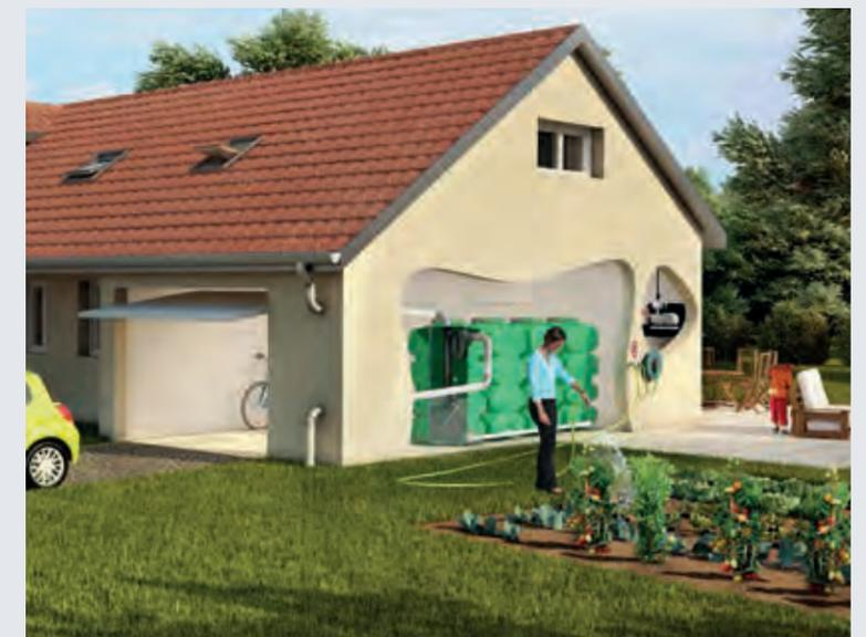
(Einbauschema AquaVario als Batterieaufstellung)
